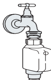
Ống cấp nước an toàn
