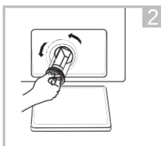
Mở bộ lọc bằng cách xoay ngược chiều kim đồng hồ
